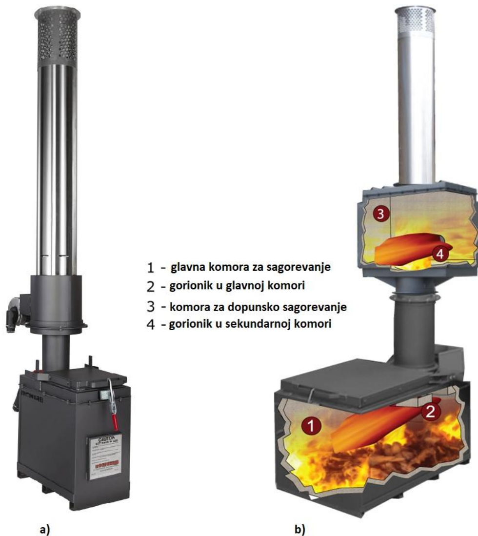
Slika 1. Izgled i osnovni delovi spalionice Inciner i8-10s
