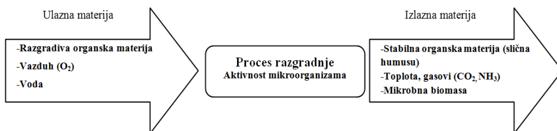
Slika 2. Ulazna i izlazna materija u procesu kompostiranja
