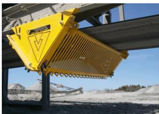
Slika 6. Zaštitna mreža u okruženju opasnog mesta (na povratnom valjku)
