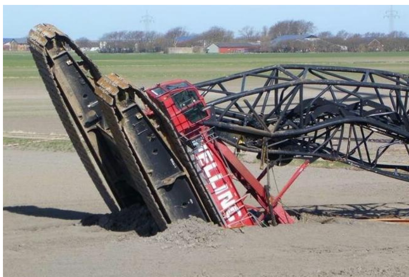
Slika 4. Gubitak stabilnosti autodizlice zbog vožnje po površini koja za nju nije namenjena
