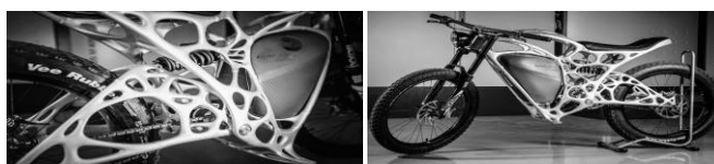
Slika 4. Primena bioničkih algoritama u topološkoj optimizaciji rama motocikla Light Rider
