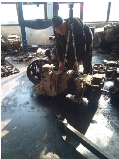
Slika 4: Postupak izgradnje menjačkog prenosnika u servisu
