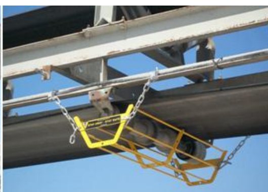
Slika 6. Zaštitna mreža u okruženju opasnog mesta (na povratnom valjku)
