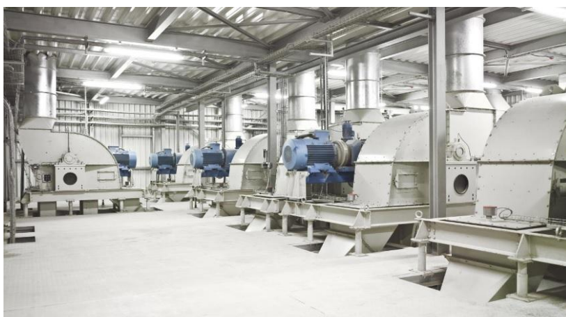
Slika 4. Primer aspiracije glava kofičastih elevatora
